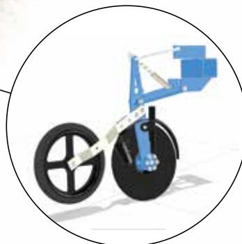
Дводисковий сошник для забезпечення рівномірних сходів
